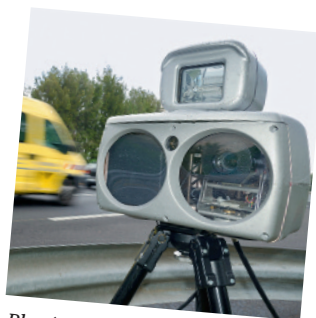
Placés le long des routes et des autoroutes et utilisés par la police, les radars tachymètres permettent de mesurer la vitesse des véhicules avec une marge d'erreur de \pm 3\% .
