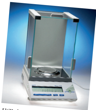
Utilisée, entre autres, par les chimistes et les pharmaciens, la balance analytique permet des mesures allant jusqu'au dixième de milligramme.
