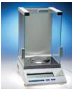
Utilisée, entre autres, en chimie ou en pharmacie, la balance analytique permet des mesures allant jusqu'au dixième de milligramme.
