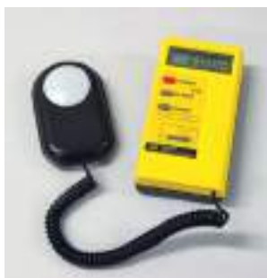
Un luxmètre, utilisé par les photographes en particulier : capteur permettant de mesurer l'éclairement ; cette mesure s'exprime dans une unité appelée « lux », et non en candela.
